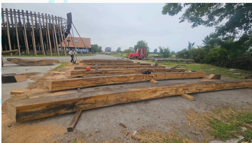
Préparation des coupes de longueur des barrots avec les angles de la coque
