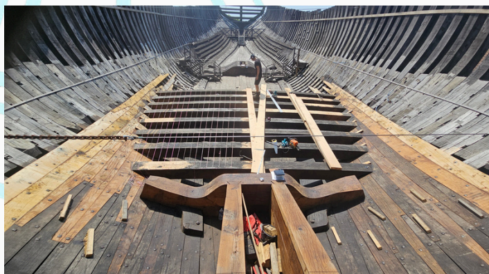
Lissage des barrots et traçage des bordés de pont (traçage rayonnant)
