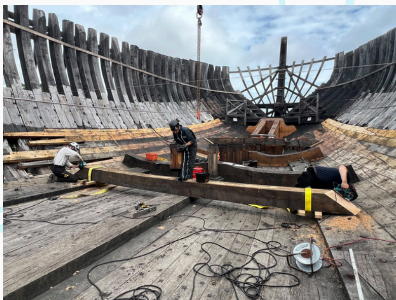
Vérification du tenon de l'épontille et ajustage si besoin
