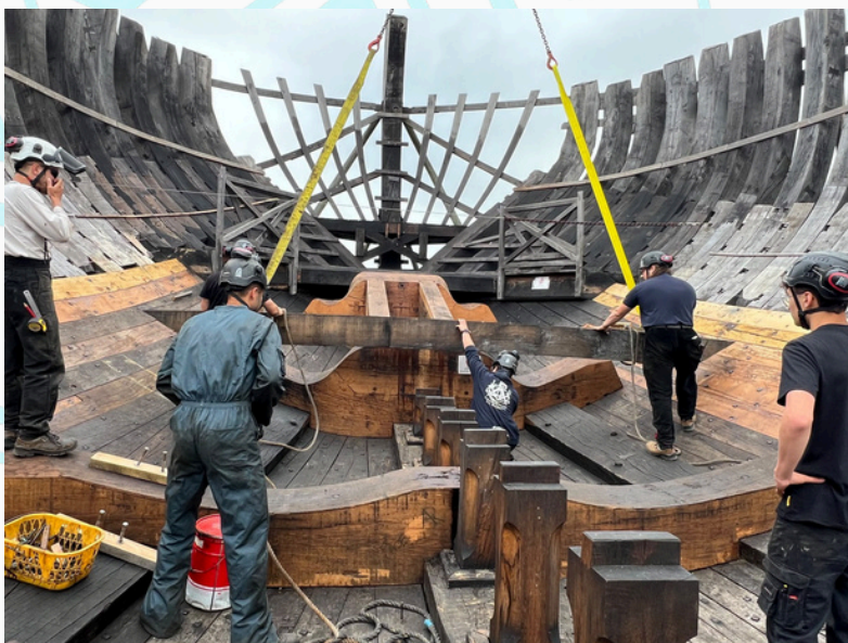
Test de positionnement du barrot
