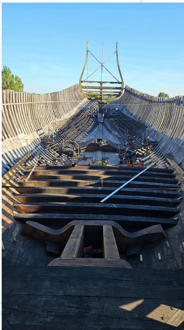
Photo d'après levage des barrots posés dans la coque
