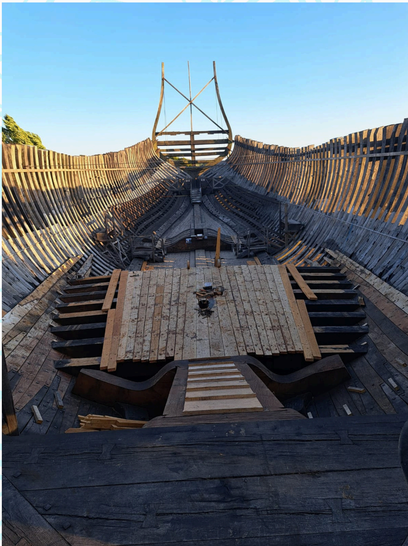
Pose des bordés de pont
