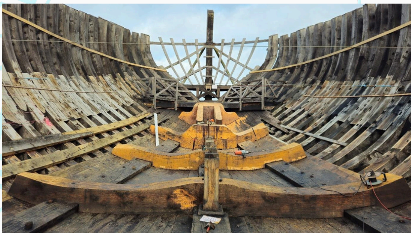
L'emplanture du mât de misaine et les deux porques de l'avant
