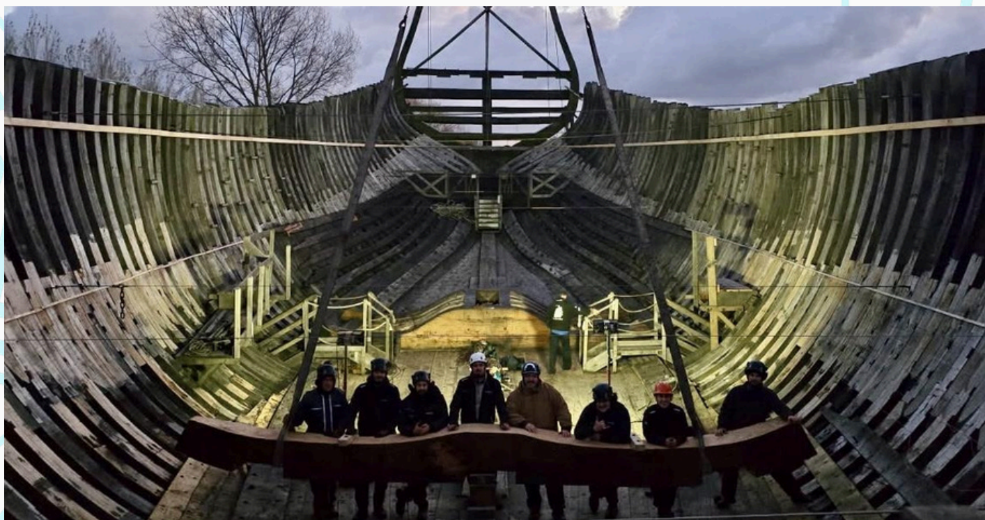
Levage de l'emplanture du mât de misaine
