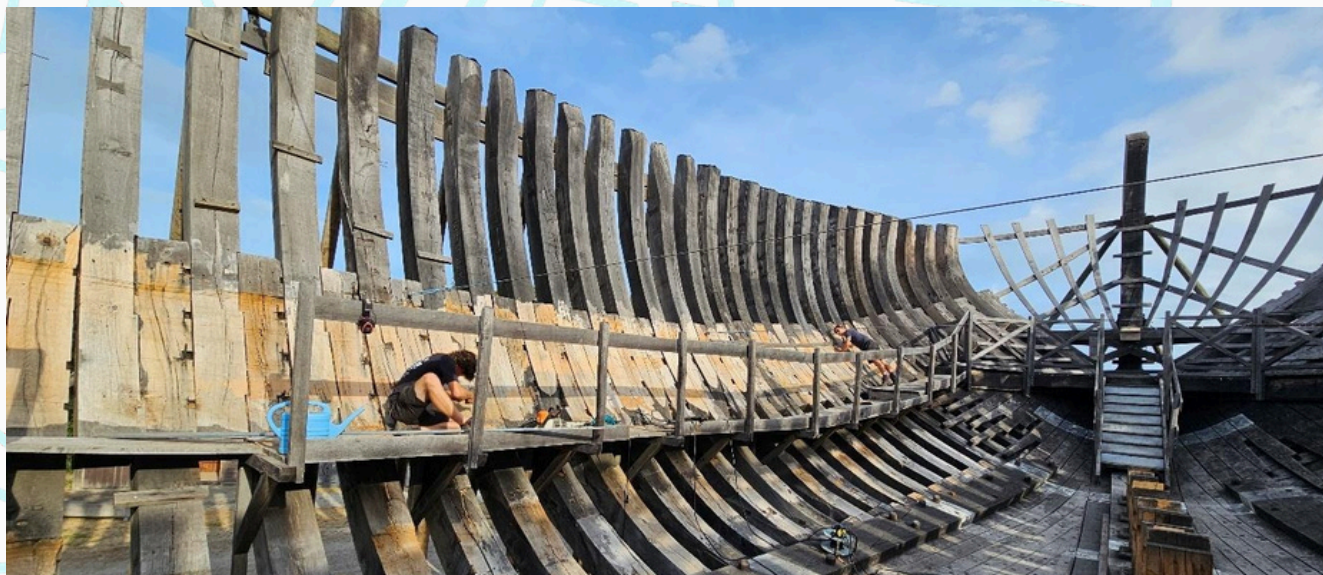
Lissage des formes avant du navire été 2025
