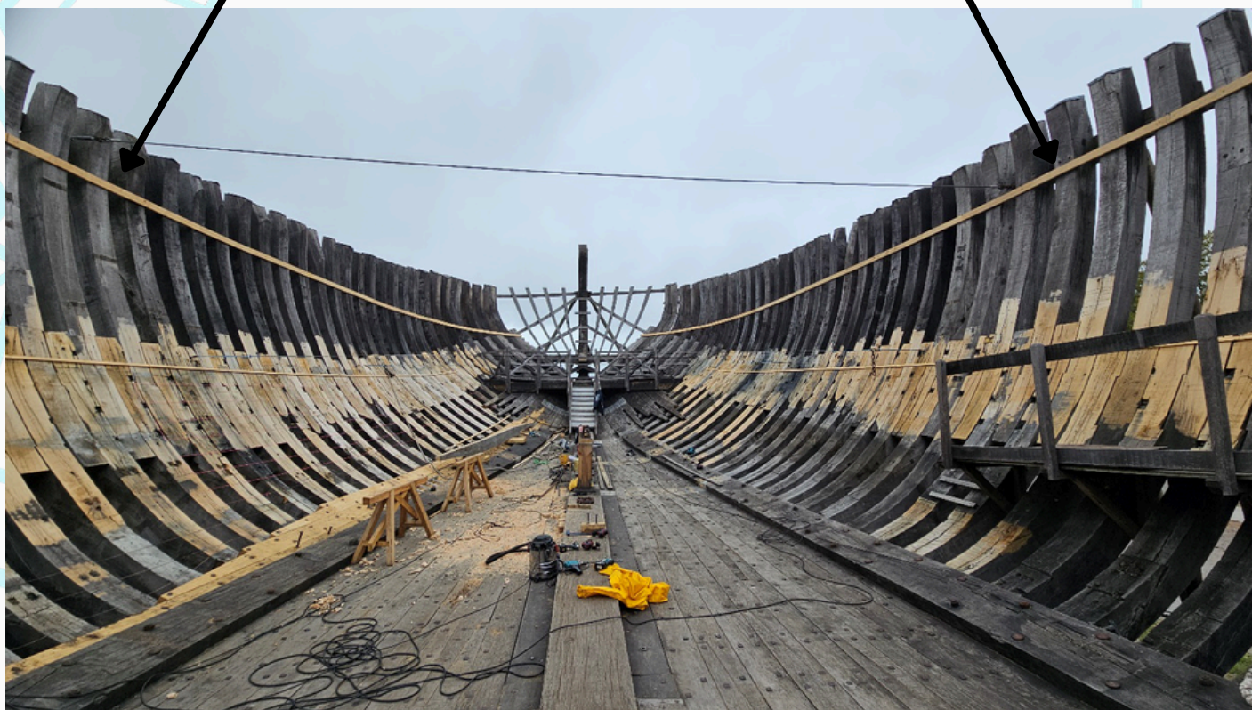
Traçage de la ligne de flottaison de jour vue vers la proue (avant)
