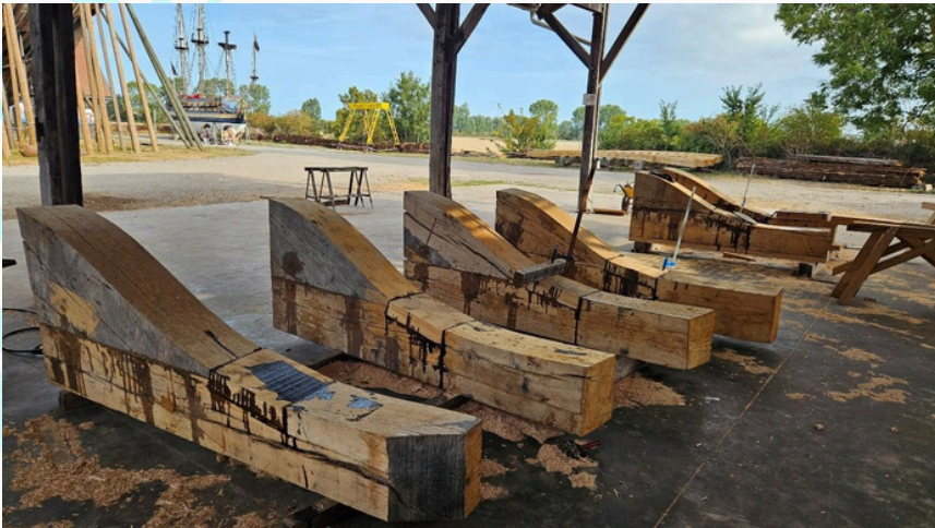
Les 6 taquets de l'implanture du grand mât
