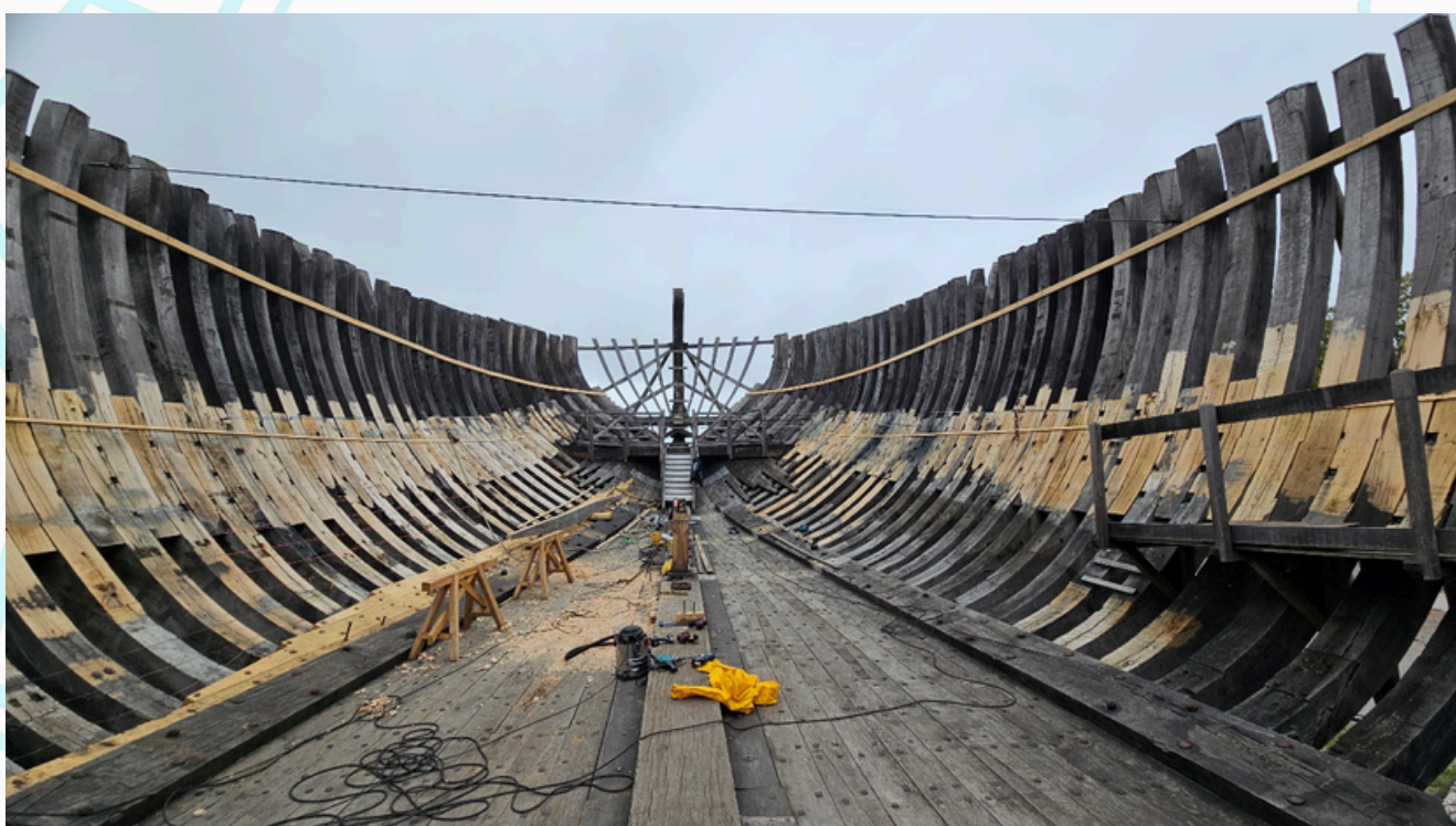
Vue de l'avant du vaisseau à l'intérieur avec la lisse qui représente la ligne de flottaison.
