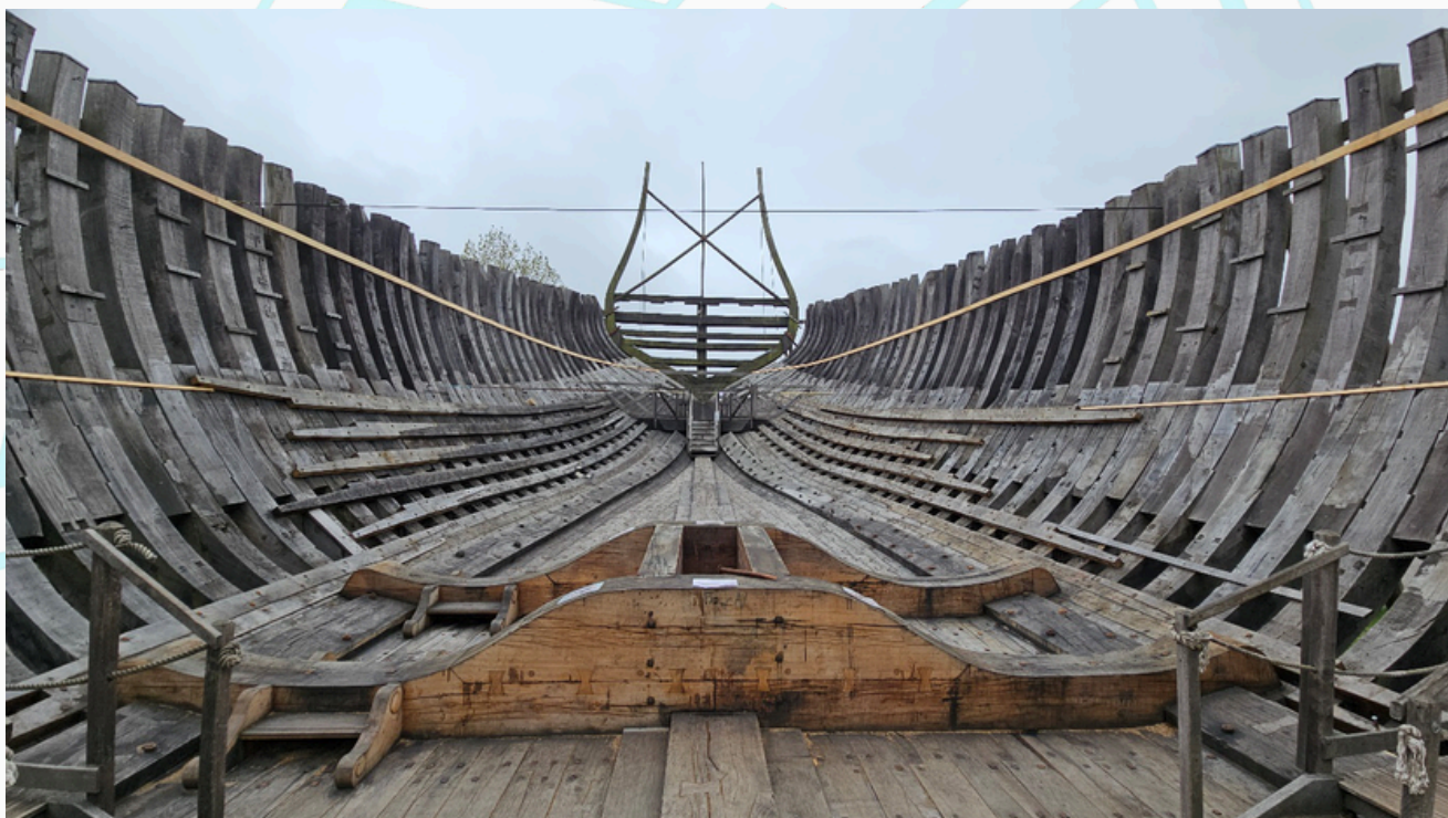
Vue de l'arrière du vaisseau à l'intérieur avec la lisse qui représente la ligne de flottaison.
