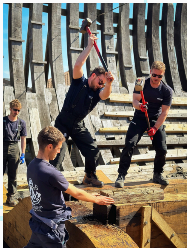
Assemblage des coulisses en queue d'aronde dans les varangues.
