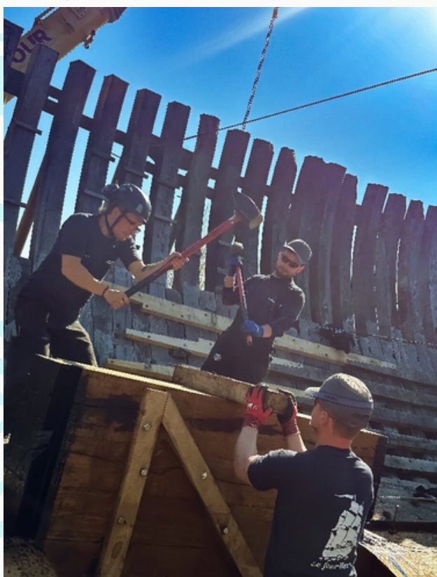
Assemblage des coulisses en queue d'aronde dans les varangues.
