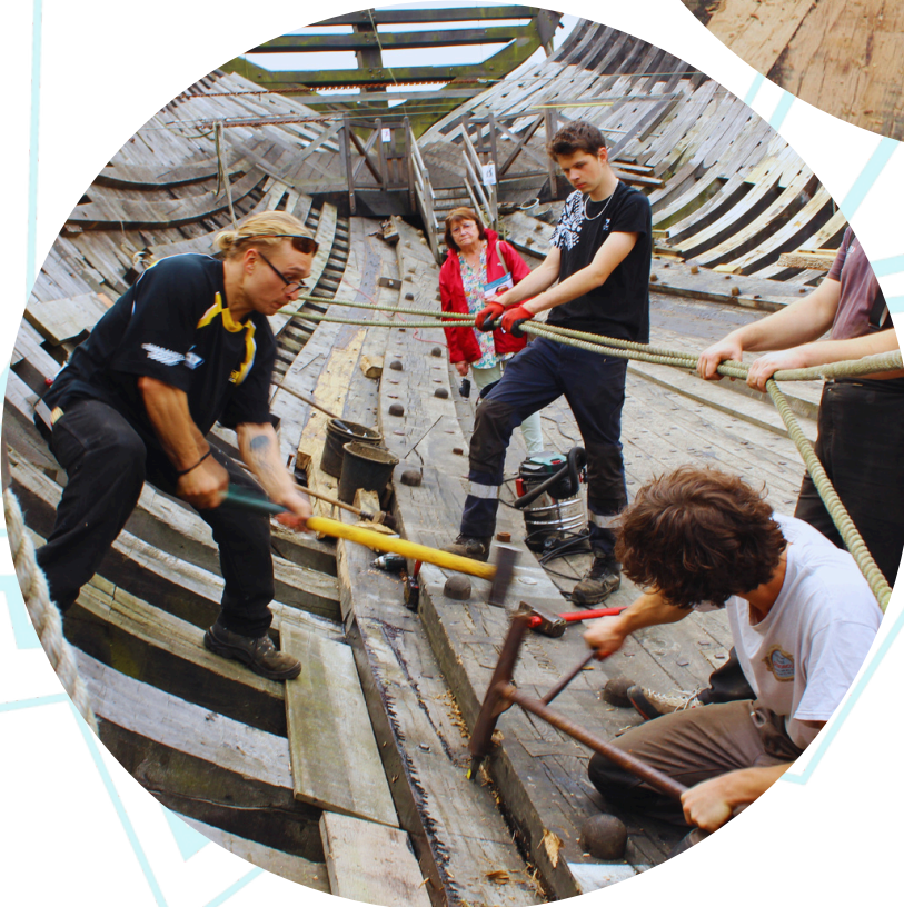
Clouage d'un vaigre contre la serre d'empature
