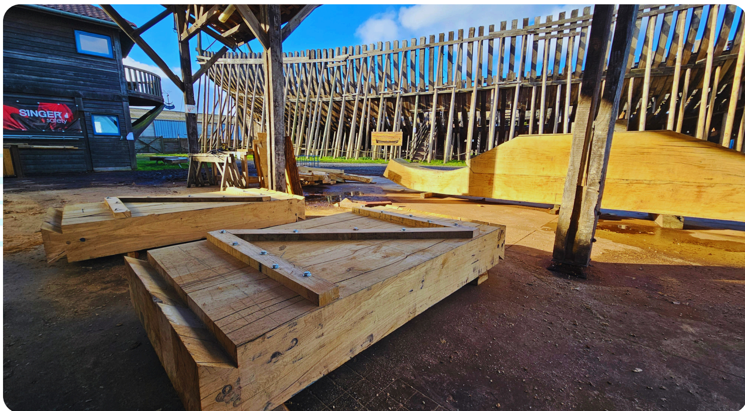
Les deux coulisses terminées et en attente du levage
