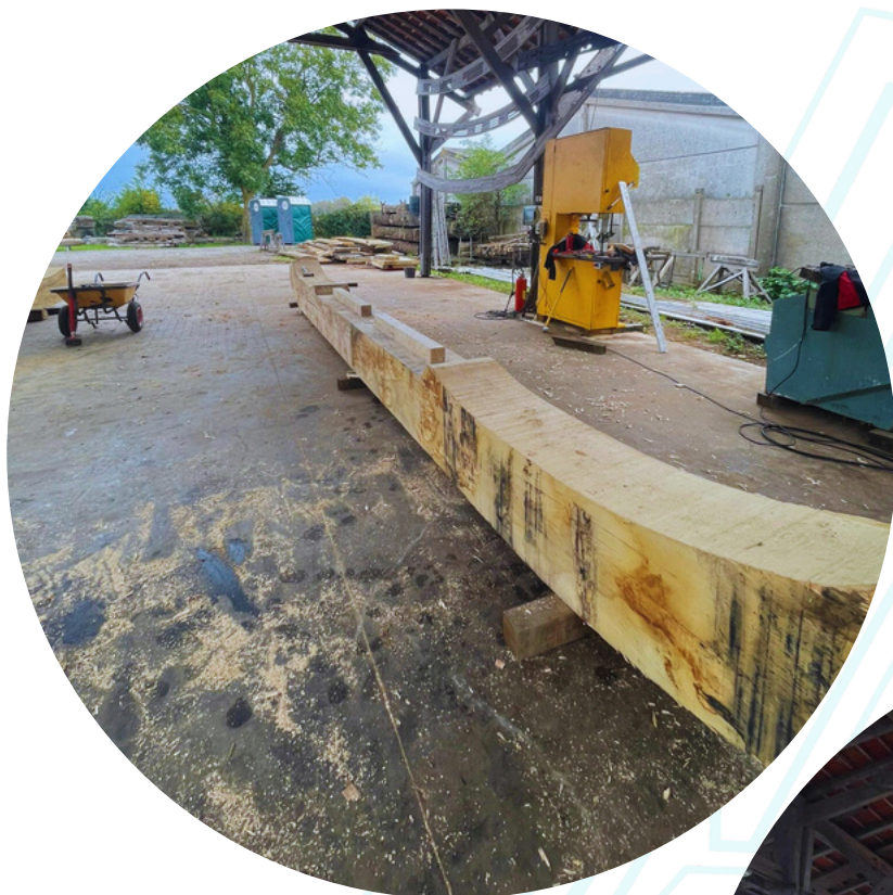
Assemblage des deux bras formant la base des varangues en queue d'aronde
