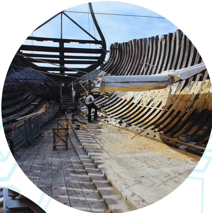
Lissage du fond de coque à l'arrière bâbord du navire
