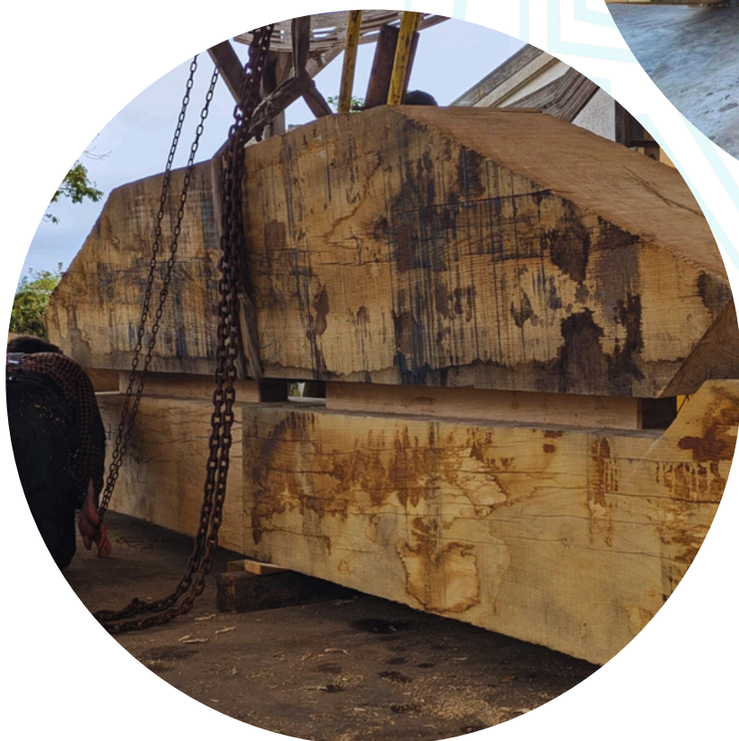
Assemblage de la partie supérieure de la varangue
