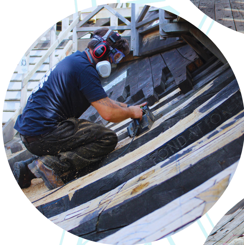
Lissage du fond avant tribord de la coque
