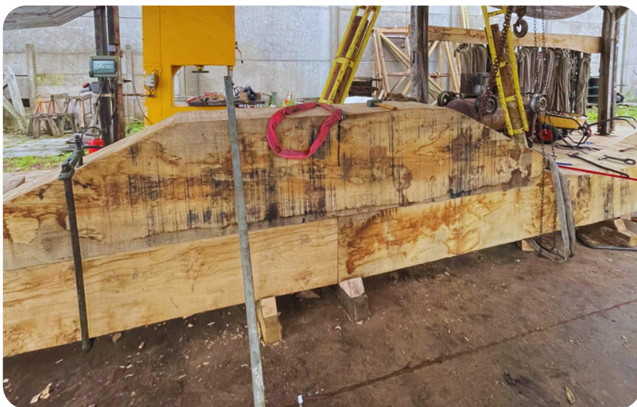
Assemblage de la partie supérieure de la varangue
