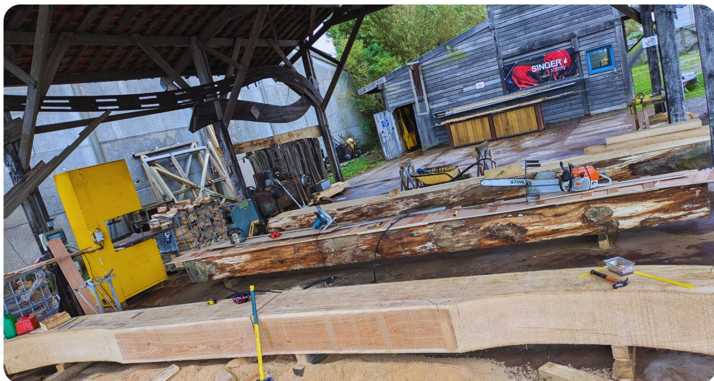
Blocs capables des bases de varangues prêts à être taillés
