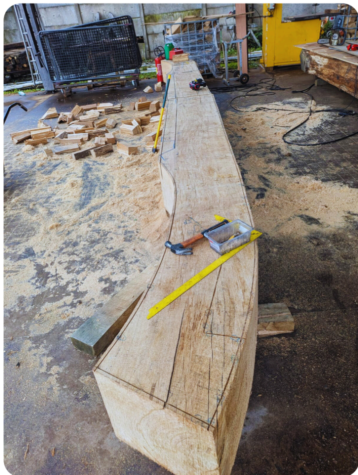
Blocs capables des bases de varangues tracés et prêts à être taillés
