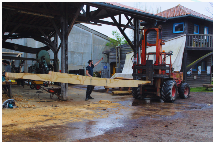
Vaigre du fond de carène prêt à être monté dans le navire
