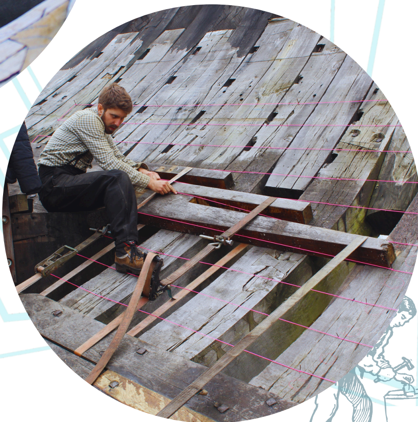
Tracage et répartition des vaigres de l'arrière babord
