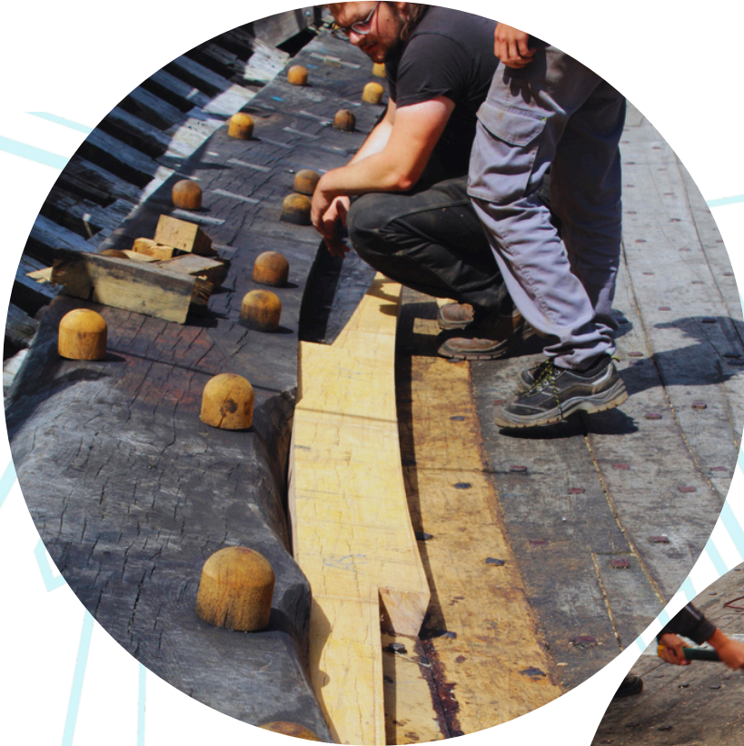
Pose d'un vaigre de clore contre la serre d'empature
