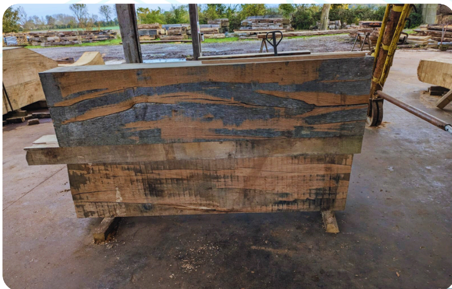
Débit des blocs capable des coulisses de l'emplanture en 3 morceaux pour arriver à une hauteur totale de 1,10m
