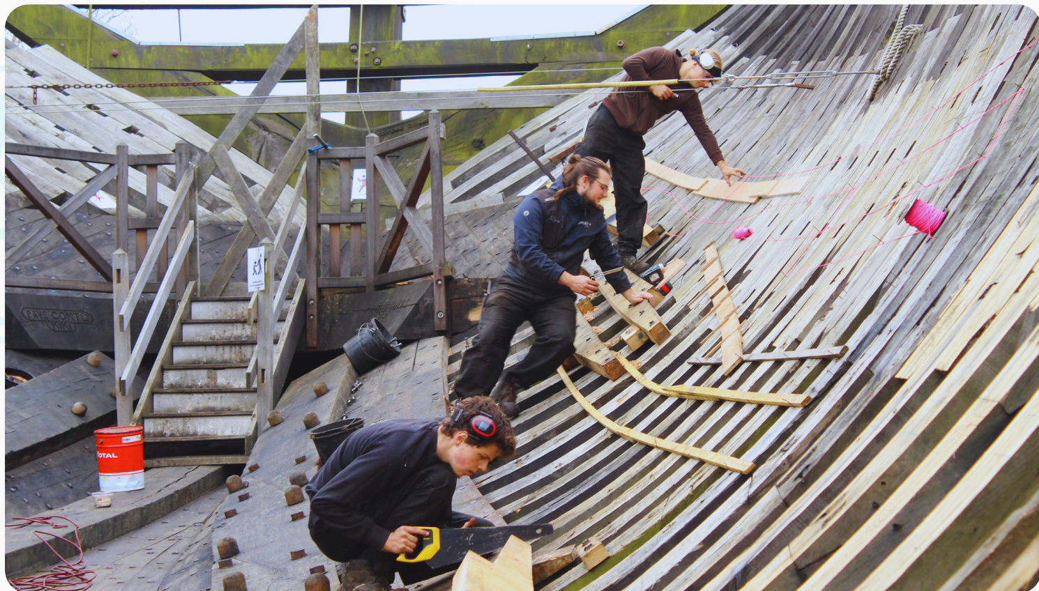
Gabarillage (brochetage) des vaigres de l'arrière
