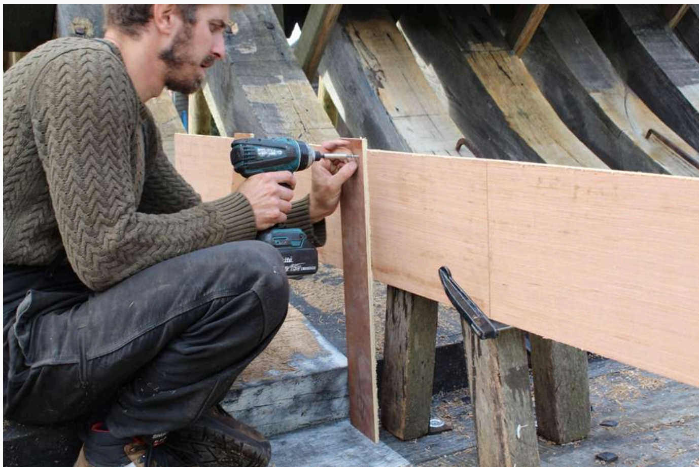
Fixation des broches (lattes de contreplaqué) pour récupérer les formes de la coque
