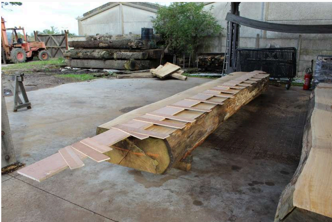
Présentation du gabarit sur un des plateaux de 40cm d'épaisseur et de 7m de long.
