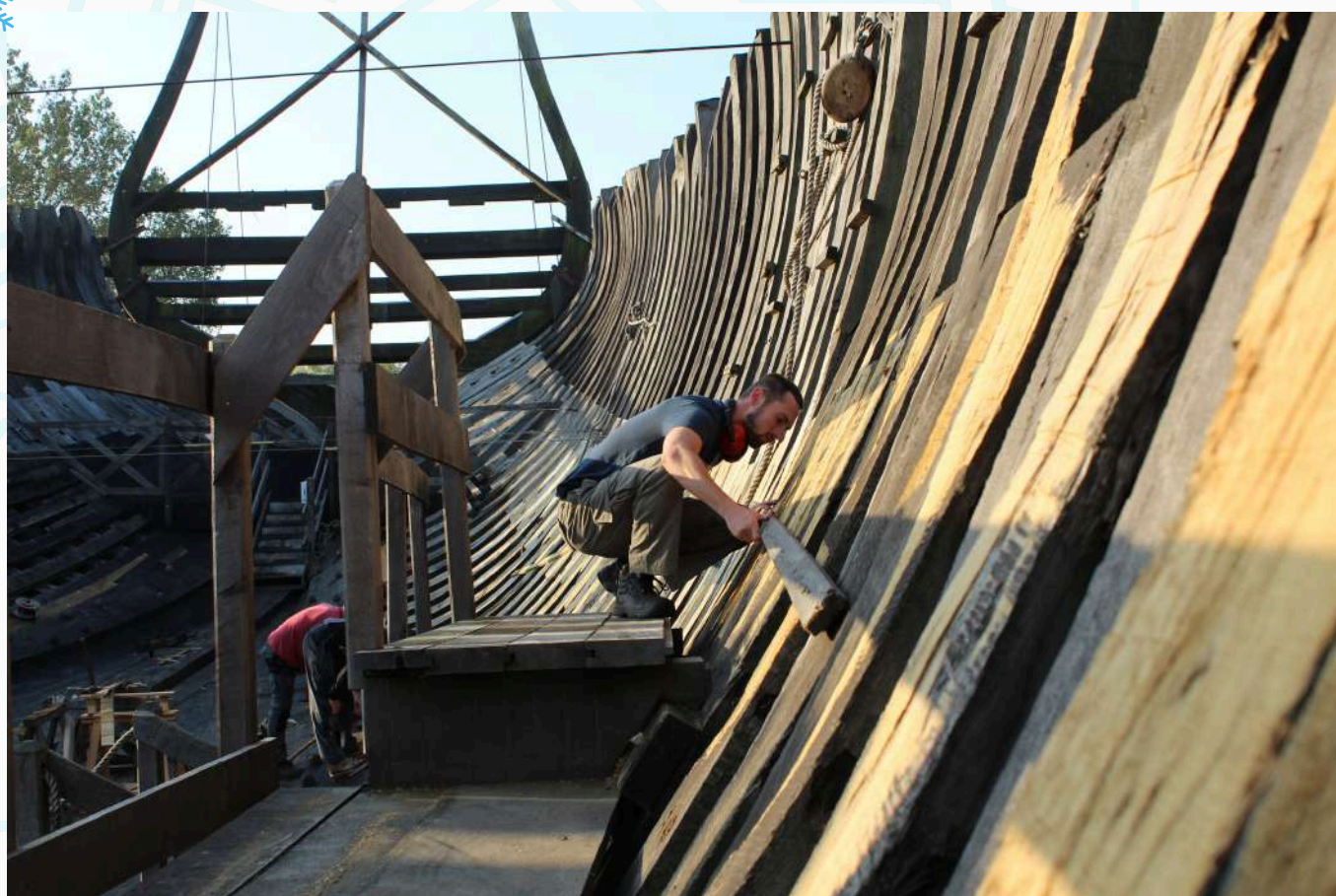
Fin du lissage des flancs arrière bâbord
