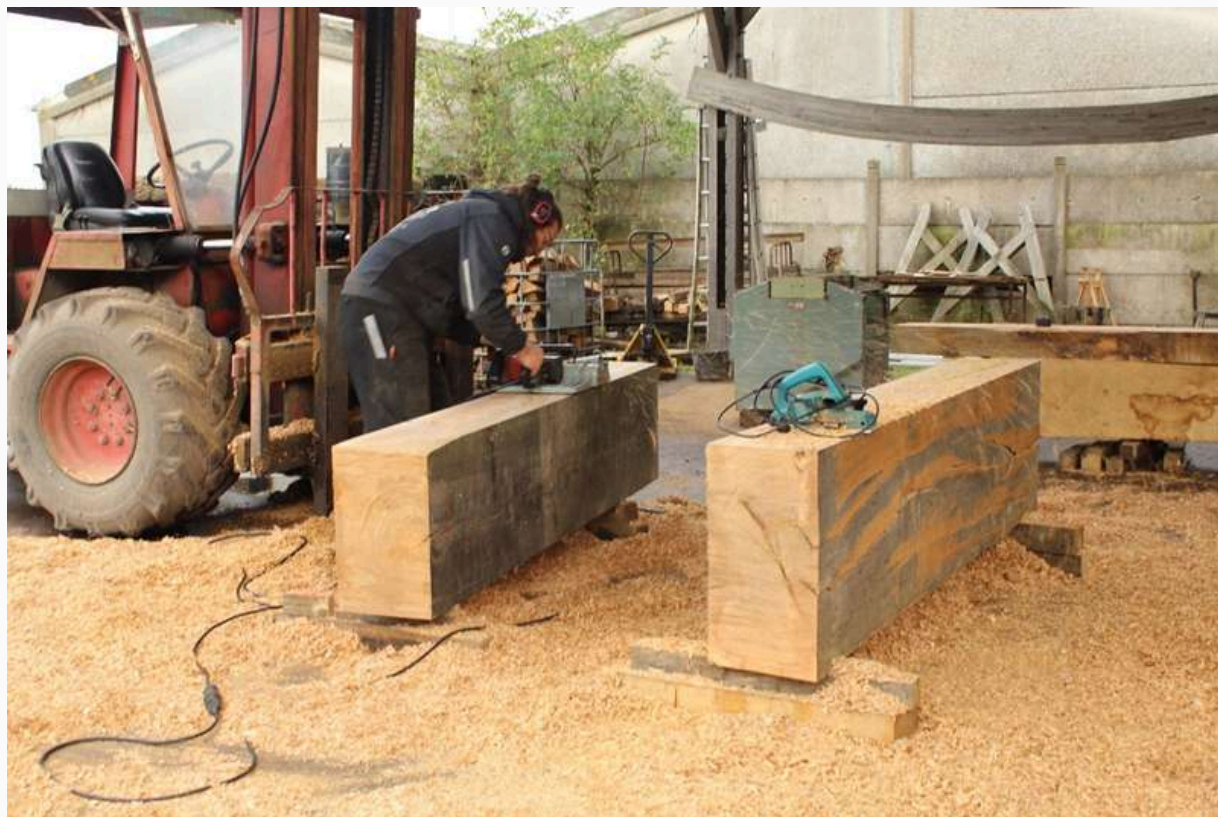
Réalisation des blocs capable des coulisses
