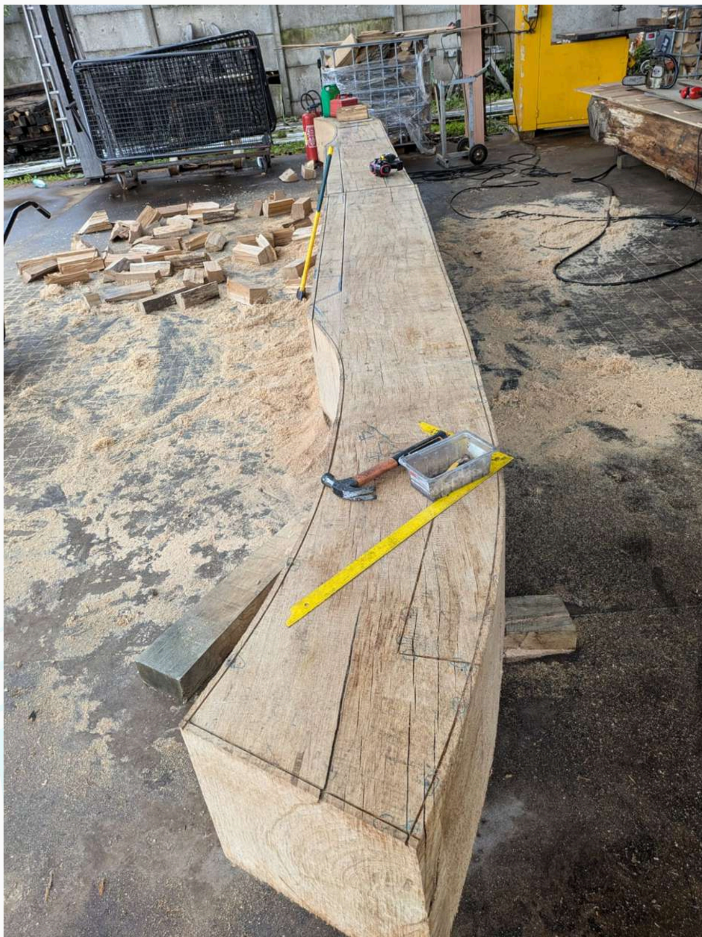
Bloc capable après découpe à la tronçonneuse
