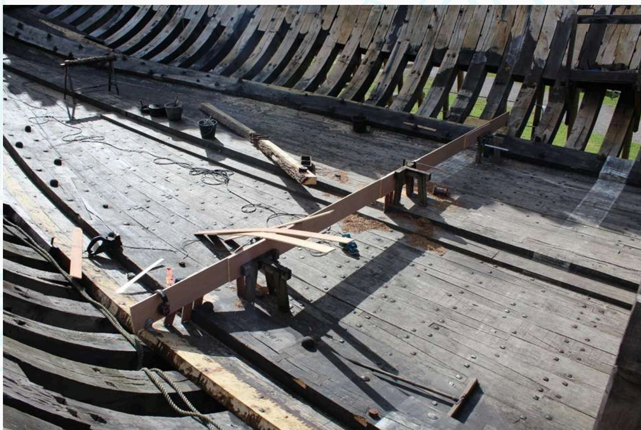
Pose de la plaque de contreplaqué au-dessus de la zone de gabariage
