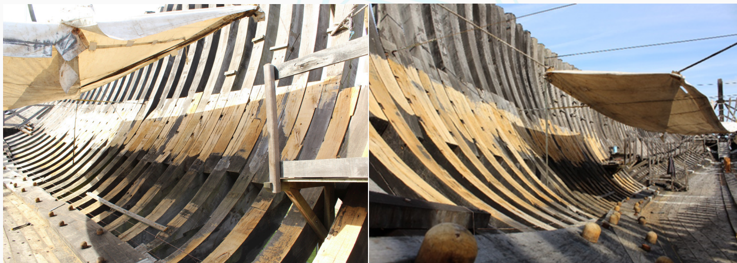
Lissage de la partie intérieure bâbord de la coque
