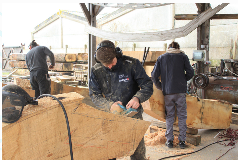
Les 6 dernières allonges de l'avant en cours de fabrication
